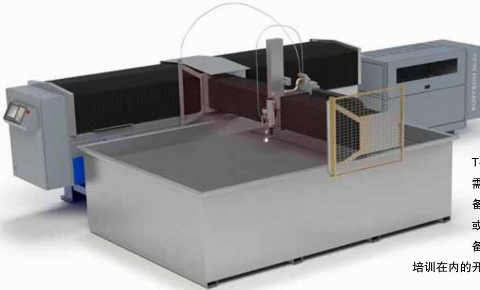
T-model 台面尺寸3x2m，适合多种需要。尤其适合原型制造、备件制备及公司内配套生产，即单件生产或者备件材料变化多样的情况。设备发运时已经完全具备包括安装和
